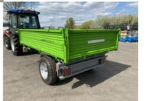
Dreiseitenkipper Einachs-Anhänger Anhänger Kipper TPS PV4000 4to, Gitteraufsatz
